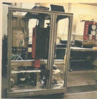
ハイパースペクトルカメラを用いた 海洋マイクロプラスチック半自動定量システム 右奥方に見えるコーヒーマシンの 自動抽出装置を応用している。
