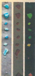
本装置で撮影された マイクロプラスチック粒子 左: 入力画像(緑色カラー) 中: 人工物ボックスの検出 右: 粒子の検出
